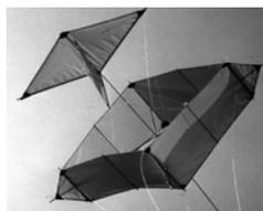
**Le cerf-volant statique à bridage déformable.** J'ai réalisé avec succès ce cerf-volant pour un vol stabilisé à près de 30° de grand roulis pour une gamme relativement importante de vent. L'idée avait déjà été essayée (nous le verrons) sur le cerf-plongeant de Herskovitz et Thomé
