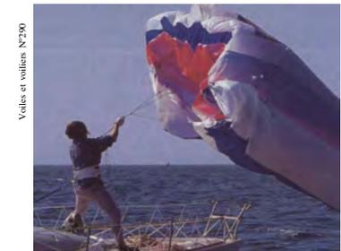
*Nicole Van de Kerchove a traversé l'Atlantique en 1995 par les alizés en n'utilisant que des cerfs-volants statiques souples. Ces principaux problèmes étaient: faible stabilité d'incidence des cerfs-volants (conçus par S. Berthomé) et difficile manoeuvre de récupération et lancement.*
