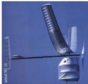
**Position de la nacelle.** L'aérosustentation présente l'avantage d'une grande liberté dans les positionnements possibles de la nacelle. Elle peut se trouver n'importe où sur le fil entre l'interface et le point de bridage du roulis. On peut alors envisager des systèmes de nacelle
