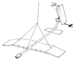
Modèle N°2. Statique à réulation d'angle de vol par peson d'empennage
