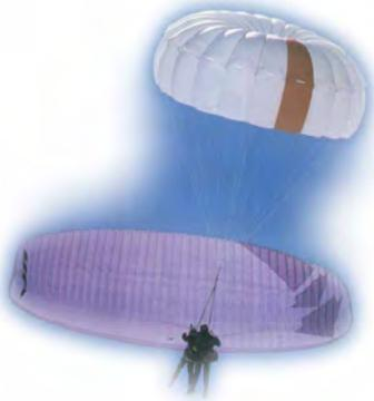
Dans le domaine du vol à voile, un fait étonnant s'est fait remarquer: si on ouvre une aile de secours alors que l'ancienne aile n'est pas neutralisée, un «*effet miroir*» provoque l'accélération stable (et dangereuse) de l'ensemble.
