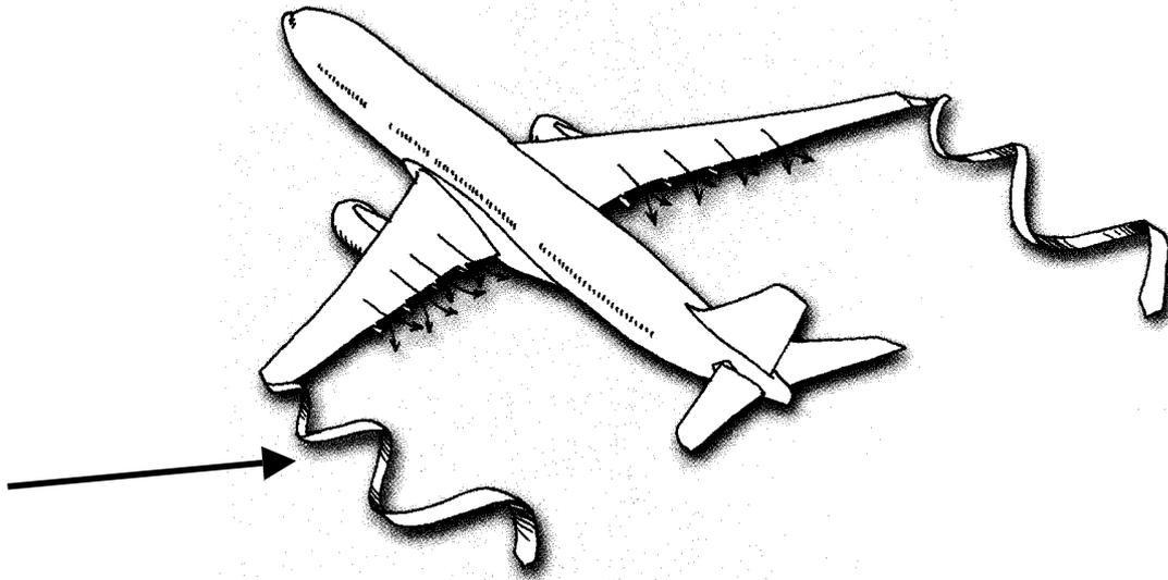
De plus, il existe sur l'extrados, une convergence des filets d'air vers le fuselage. Sur l'intrados, les filets d'air dévient vers l'extérieur de l'aile. Lorsqu'un filet d'air supérieur rencontre un filet d'air inférieur, après le bord de fuite, il se forme là aussi des tourbillons, qui vont se fondre dans les Vortex.
