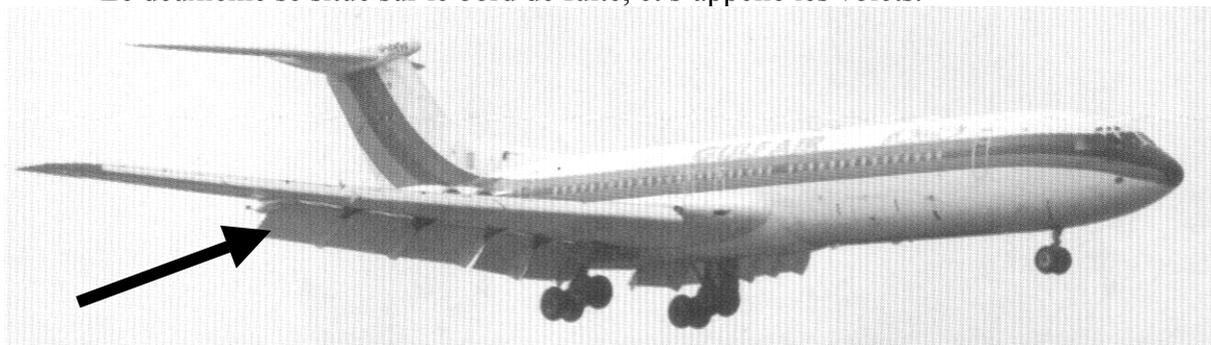
Dans les deux cas, ils servent à augmenter la surface de l'aile et sa courbure .
