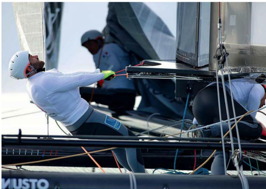
**Ajustements.** Bouts et palans situés à la base sur le cadran permettent de cambrer et twister l'aile. Ici Devan Le Bihan lors d'un virement dans le petit temps.
