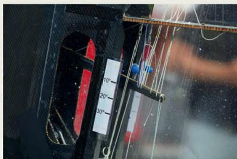
**Repères.** Réglettes et palans sont visibles à travers le film translucide, comme ici sur une aile de Class C.
