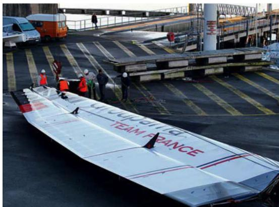
**Grutage.** Chaque manipulation de l'aile – 21 mètres et 395 kilos – mobilise au minimum une dizaine de personnes... et si possible pas ou peu de vent !
