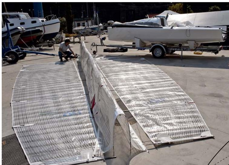
**Proto.** Les trois panneaux s'assemblent par zip mais l'assemblage est encore fastidieux. La cambrure se règle par palans qui remplacent le vérin de l'Elan 37.
