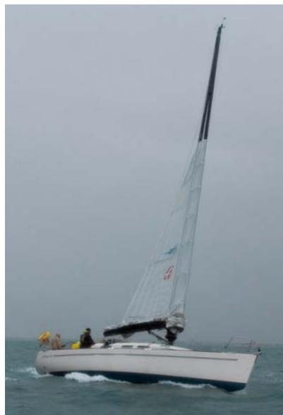
**Profil impeccable, l'Omer Wing Sail bénéficie de l'expertise carbone de Formula Marine et a l'avantage d'être peu intrusive à l'intérieur. Le système de réduction doit néanmoins être amélioré.**
