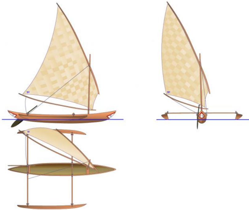
Trimaran de Zanzibar, qui navigue encore de nos jours. Notez les flotteurs inclinés vers l'extérieur. Plan © François Chevalier
