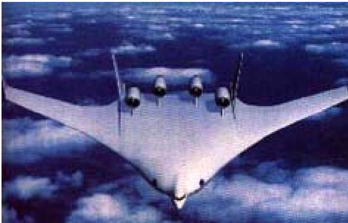
C'est le concept de l'aile volante qui peut contenir ce volume de passagers avec une longueur de 54 m pour une largeur d'environ 40 m (à comparer avec 8 m de diamètre pour un avion conventionnel de type Boeing-747). L'aile volante présente un avantage important par rapport à un avion conventionnel :
