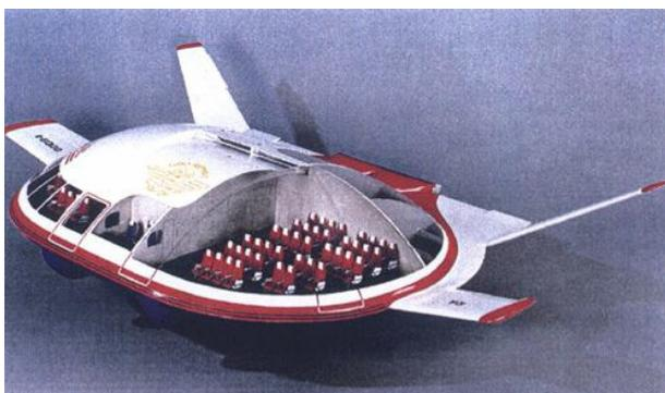
Matériaux composites : Le principe du coussin d'air permet d'éliminer des concentrations des efforts sur les parties structurales de l'appareil, qui peuvent alors être faites des matériaux composites.
