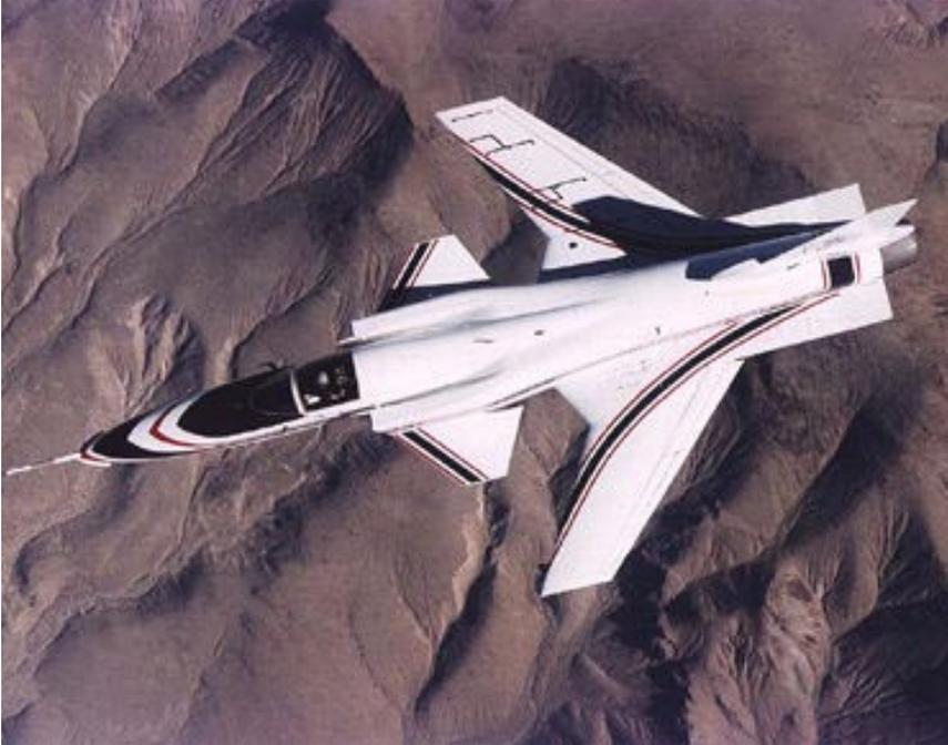
Les « forward-swept wing » - ailes en flèche inclinées vers le devant de l'avion donnent l'impression de voler a reculons. Ces ailes sont le plus souvent attachées loin à l'arrière du fuselage. Sur ce type d'avions de petites ailes appelées « canard » sont souvent positionnées sur le devant du fuselage.
