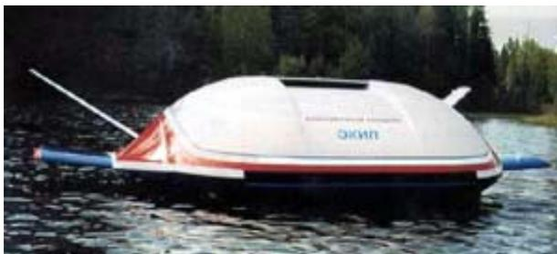
Ecologie/ utilité : L'utilisation de l'hydrogène comme carburant permet de franchir une distance de transport de 2 à 3 fois supérieure à celle d'un avion cargo classique. Grâce au coussin d'air, les vitesses de montée et d'approche sont faibles ce qui réduit considérablement les émissions sonores.
