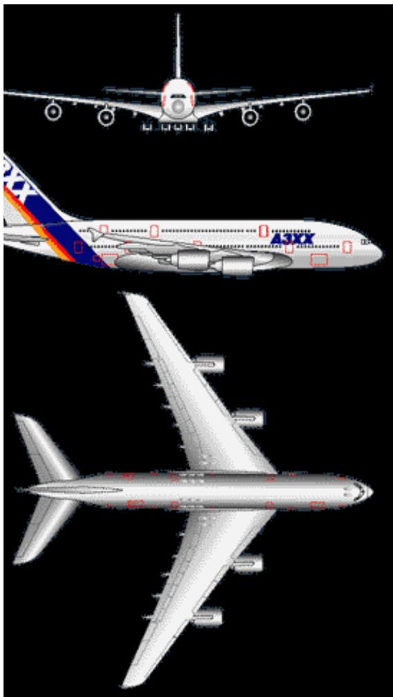
Les ailes en flèches (« swept-wing ») s'étendent vers l'arrière de l'avion avec un angle par rapport au fuselage. Ces ailes sont les plus répandues de nos jours tant pour les avions de ligne que pour les avions transporteurs
