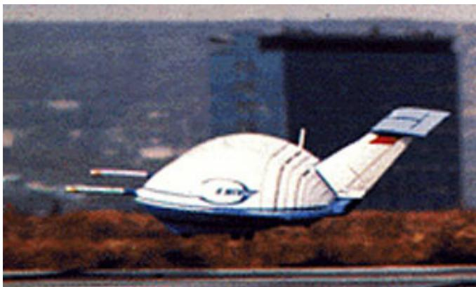
L'utilisation de tuyère à poussée vectorielle permet d'assurer un contrôle actif sur le tangage de l'appareil.
