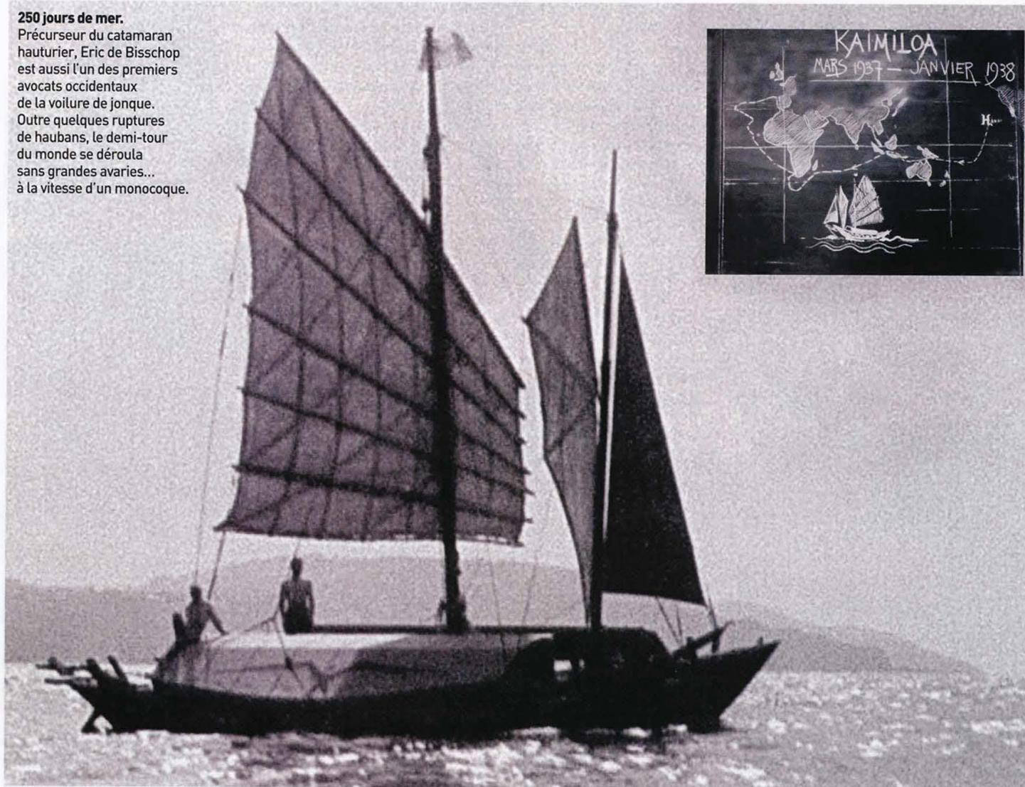
carrés (pour approximativement 11 tonnes en charge et 10,60 mètres de long !) se compose d'une grand-voile envoyée sur le grand mât et d'une curieuse voile, sorte de fisherman chinois, envoyée sur le mât de misaine qui porte également un foc.
