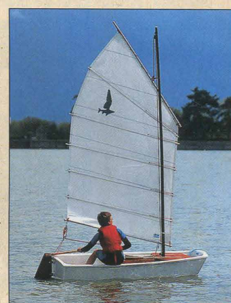
Ragage. S'établissant parfaitement grâce à ses lattes, ce gréement entraîne beaucoup de frottements.
