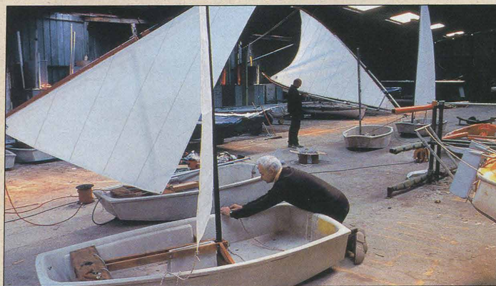
Bricolage. Il a fallu dix jours pour adapter les Optimist. Mâts et vergues sont constitués de morceaux d'espars de planches à voile.
