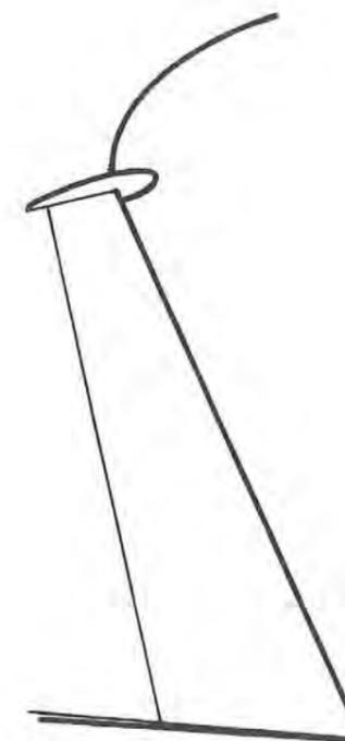
Fig. 7-23 • Plaque d'extrémité montée à la partie supérieure du volet de bord de fuite d'*Intrepid* en 1967.
