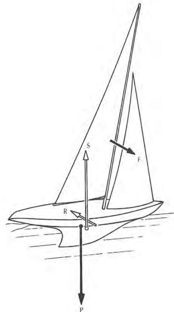
Fig. 3-8 • Aux allures du près l'équilibre reste toujours la propriété des deux couples constitués par les forces de la voilure **F** et de la carène **R** d'une part, le poids **P** et la sustentation **S** d'autre part.
