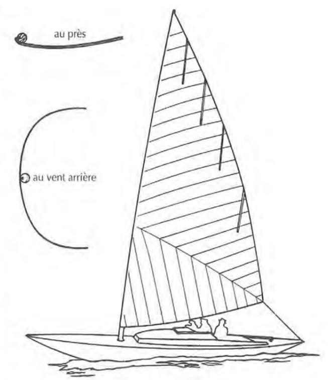
Fig. 6-4 • Dans le gréement LJUNGSTRÖM la voile (en double épaisseur pour s'ouvrir au vent arrière) s'enroule sur le mât pivotant.
