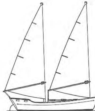
Fig. 6-50 • L'ultime simplification du ketch : le *Freedom 40* est muni de deux voiles sur mât non haubané avec bôme à whishbone reprenant le gréement des vieux sharpies de New-Haven. La réduction de surface se fait par un système de ris.
