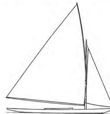
Fig. 6-41 • Grand-voile houari à faible allongement, foc de surface réduite, le sloop de course tel qu'on le voyait à la fin du siècle dernier. *Unorna* de Ch. SIBBICK - 1894.
