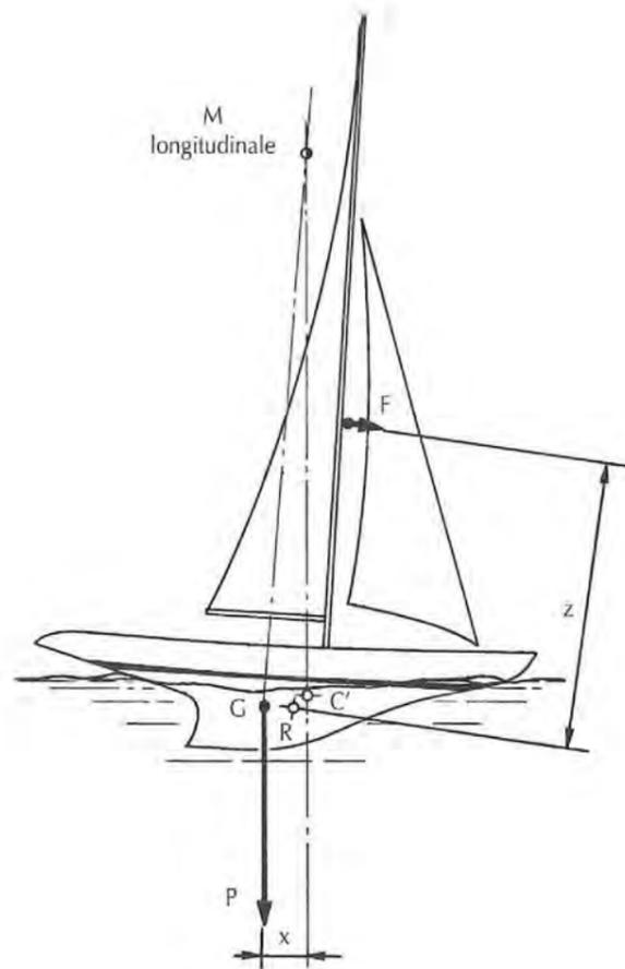
Fig. 4-41 • La stabilité longitudinale est obtenue, comme la stabilité transversale, pour un décalage du centre de carène, créant un moment de redressement  $P \times x$  égal au moment inclinant  $F \times z$ .
