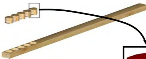
④ Usinage de la surface non plane du cylindre de bambou pour arriver à un cylindre le plus parfait possible
