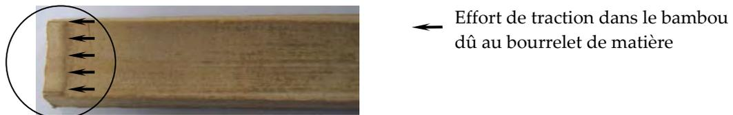
Bourrelet de matière fibreuse : le matériau à cet endroit est sollicité à la fois en frottement et en traction longitudinale
