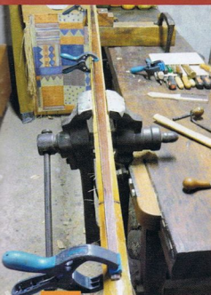
Placement du gabarit légèrement surdimensionné (pour limiter les erreurs de découpe) sur la lame de bambou
