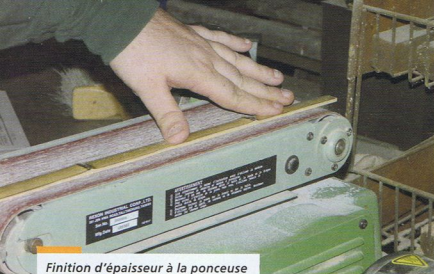
Finition d'épaisseur à la ponceuse
