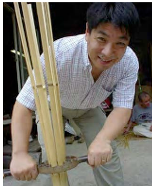
4- découpe du chaume en baguettes.
