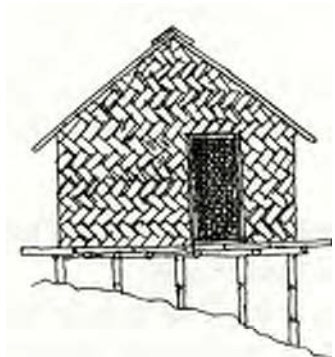
Ci-dessus : Habitation sur pilotis en Birmanie. Toiture en bardeaux de bambou, cloisons en panneaux de bambou tressé.
