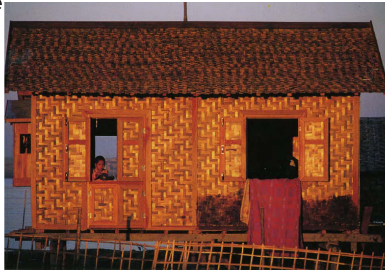
Ci-dessus : Habitation sur pilotis en Birmanie. Toiture en bardeaux de bambou, cloisons en panneaux de bambou tressé.
