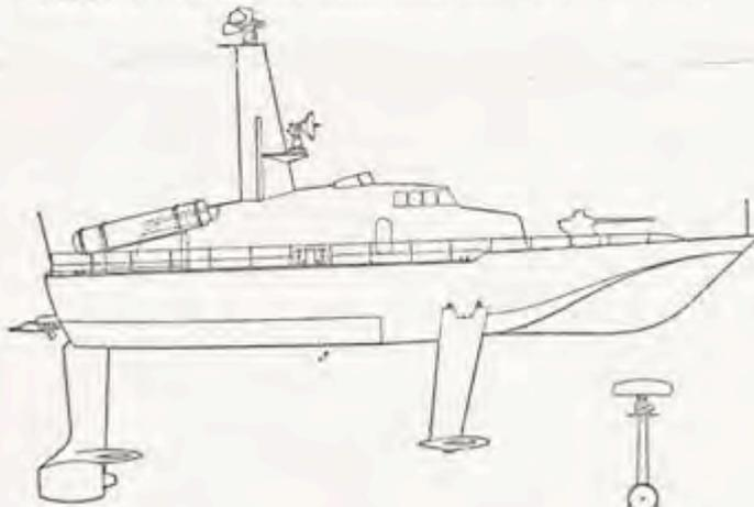
Plan trois-vues schématique du futur SA 805. En haut du mât, l'antenne de radar de veille; à mi-hauteur, l'antenne du radar de tir; à l'avant, le canon bitube de 30 mm; à l'arrière, les deux rampes de lancement des « Exocet ». On remarque, sous le plan porteur arrière, le propulseur Sogreah.
