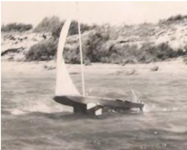
Je conçus donc un voilier monocoque pourvu d'ailes marines rattachées directement à la coque et repliables sur le pont par simple rotation. La coque elle-même devait être du type "SCOW" c'est-à-dire avec un fond en W.
