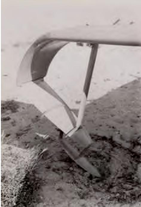
Le plan supérieur, d'une surface de 25 dm<sup>2</sup> environ, est pourvu d'un profil semi-lenticulaire à bord d'attaque tranchant. Il comporte en outre 2 cloisons d'extrados.
