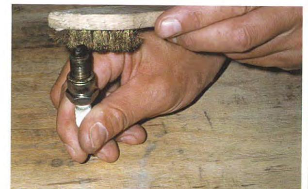
4 Un nettoyage à la brosse douce permet d'éliminer les dépôts et autre résidus de combustion
