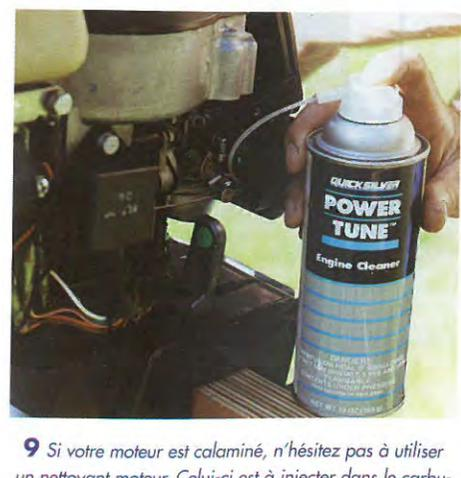
9 Si votre moteur est calaminé, n'hésitez pas à utiliser un nettoyant moteur. Celui-ci est à injecter dans le carburateur. Après avoir provoqué la panne sèche pour vider les différents éléments du circuit d'alimentation. Nettoyez la tête motrice, puis pulvérisez un produit hydrofuge.
