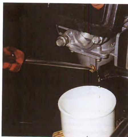
7 ... par la vis de purge, afin d'éviter les différents dépôts.
