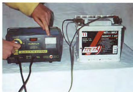
4 Ne dépassez pas l'intensité de charge. Exemple : batterie de 45 Ah = maximum admissible 9 A.
