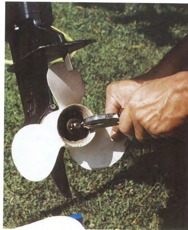
1 Dépose : retirez la goupille ou redressez la rondelle frein.
