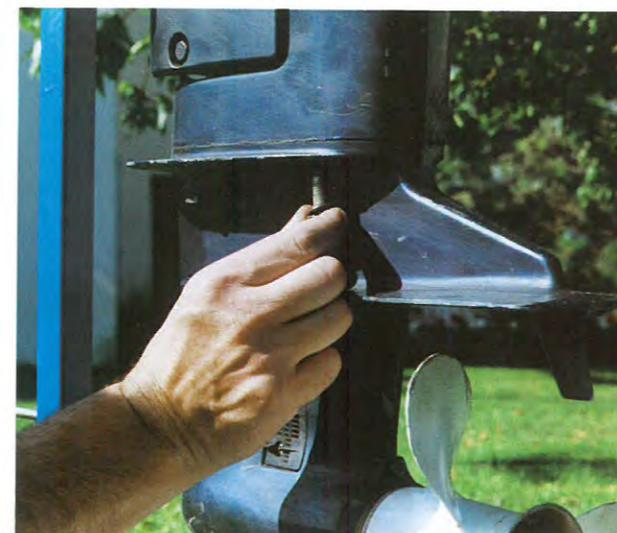
1 Interrompre en premier lieu, le mode de liaison du système d'inversion de marche de l'inverseur puis, dévissez les vis de fixation.
