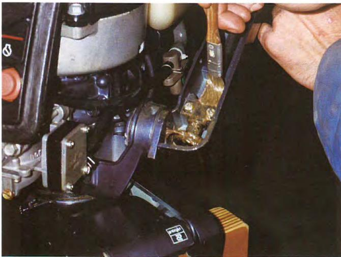
1 La lubrification des articulations est assurée à l'aide d'un pinceau et de graisse marine.
