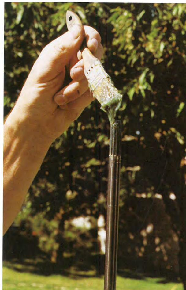
3 Avant la repose de l'embase, ne pas oublier de nettoyer puis de graisser les cannelures de l'arbre moteur.
