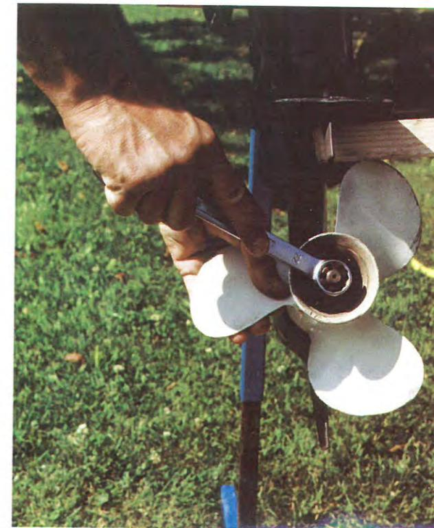
2 Pour débloquer l'écrou et empêcher l'hélice de tourner, placez une cale de bois entre la plaque anti-ventilation et l'hélice.
