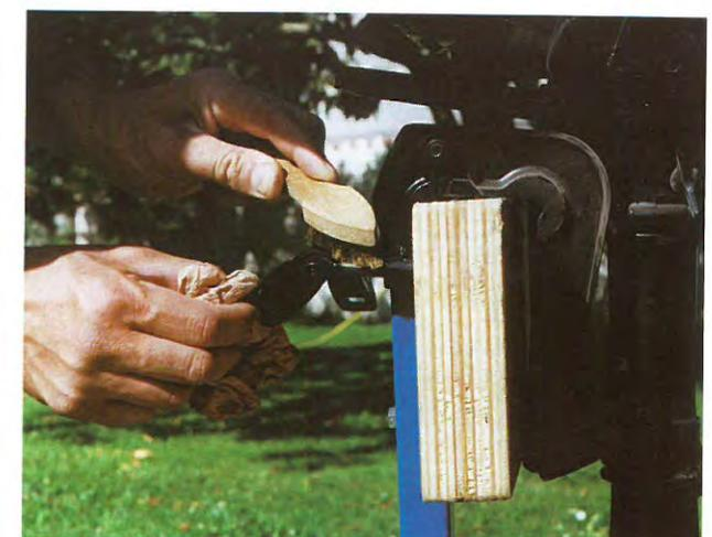
5 Encore un élément de confort à soigner : les vis de presse. Un brossage suivi d'un nettoyage à l'essence évitera tous blocages ou point dur.
