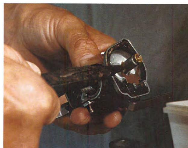
**11** Ajustez la hauteur du flotteur en tordant très légèrement la languette d'appui.
