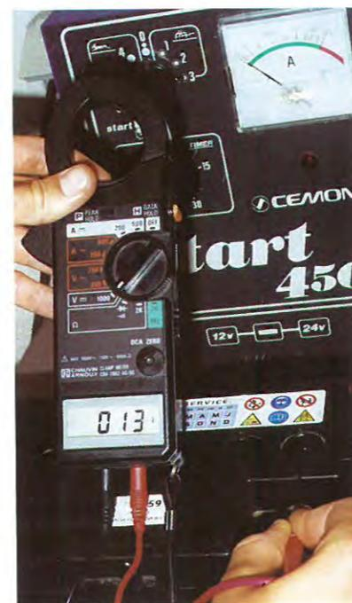
Dans le cas d'une batterie dite sans entretien, utilisez un voltmètre gradué en dixième de volt ou un voltmètre numérique.
