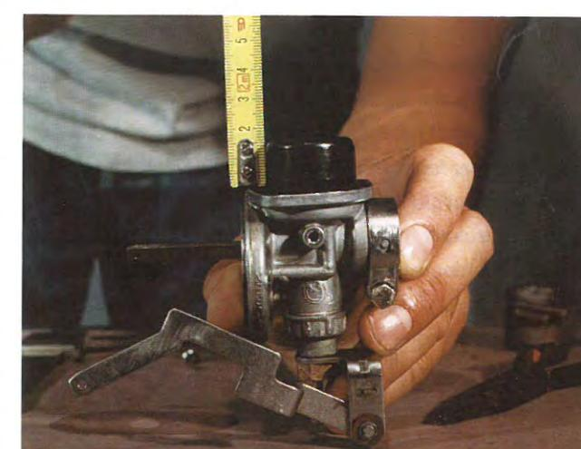
**10** A l'aide d'un réglet, vérifiez le niveau de cuve.
