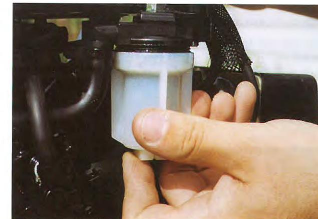
2 Sur la plupart des moteurs, le filtre à essence est accessible. Il suffit de dévisser la cuve pour avoir accès à l'élément filtrant.
