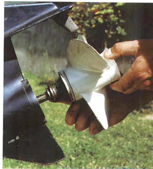
3 Retirez l'hélicé. Si besoin, la décoller à l'aide d'un maillet en tapant sur le moyeu
