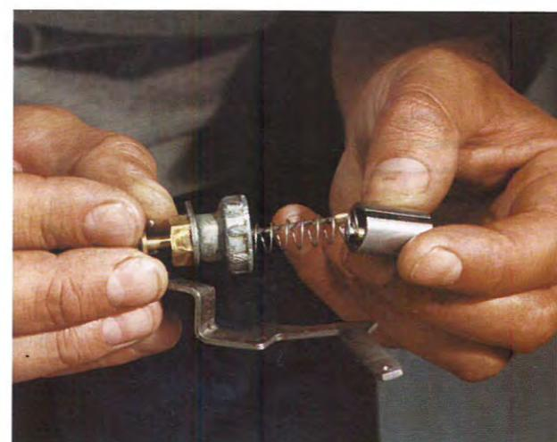
**9** Contrôlez l'ensemble boisseau/aiguille. Celui-ci doit coulisser sans point dur dans le corps du carburateur. Dégagez l'ensemble boisseau/aiguille.
