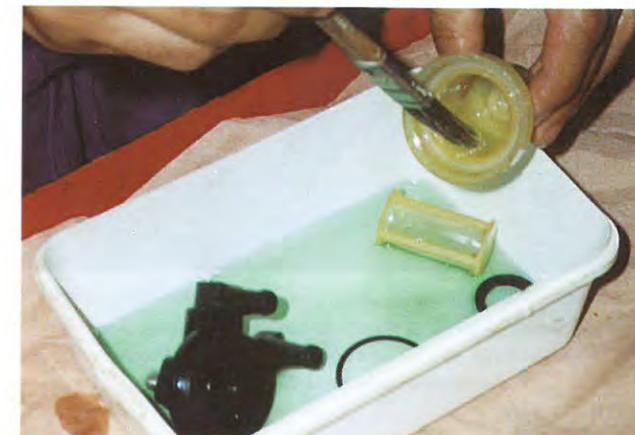
4 Nettoyez l'élément filtrant et la cuve avec un pinceau et de l'essence. Achevez si possible le nettoyage par un séchage à l'air comprimé.
