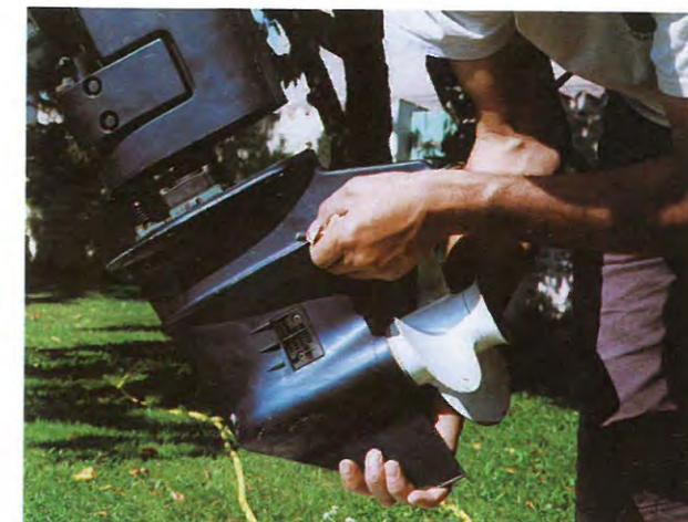
4 Repose : guidez l'embase puis resserrez progressivement les vis de fixation.
