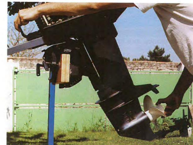
5 Contrôlez le système d'inversion de marche. Au point mort, l'hélice doit tourner librement. Réglez si nécessaire en agissant sur le mode liaison de l'inverseur.
