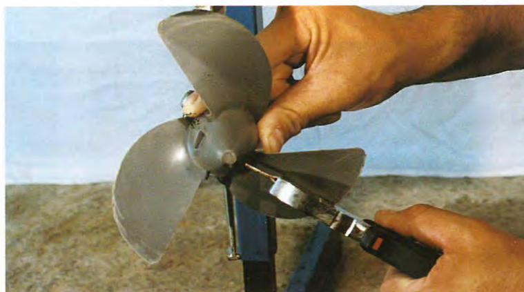
**1** Démontez l'hélice, vérifiez l'état des pales. S'assurer qu'aucun fil de pêche ne s'est enroulé autour de l'arbre d'hélice.
