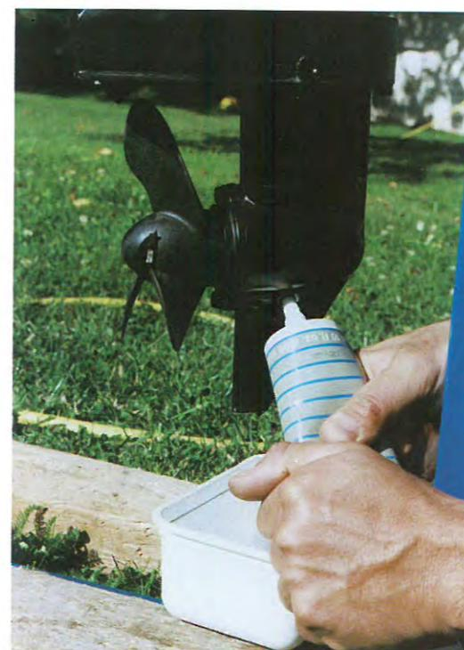
**3** Assurez-vous que la vis d'évent est enlevée, avant de remplir l'embase d'huile. Le remplissage s'effectue par l'orifice inférieur, moteur en position verticale.
