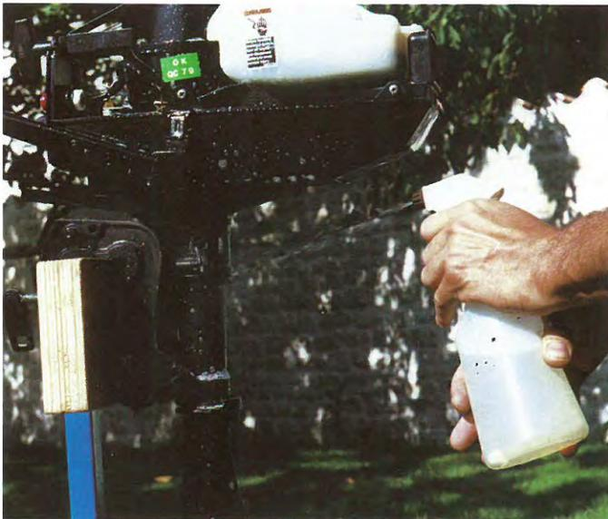
2 Pulvérisez un détergent sur l'ensemble du moteur. Nettoyage au pinceau.
