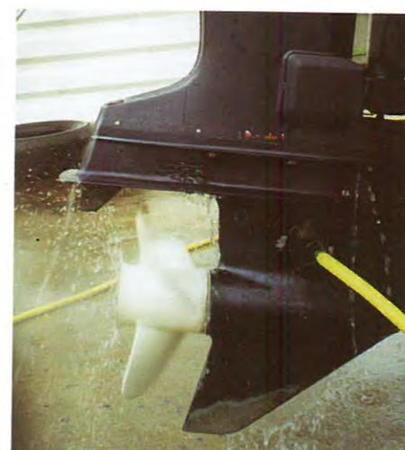
4 Des oreilles placées de part et d'autre de la prise d'eau permettent un rinçage efficace des moteurs hors bord.
