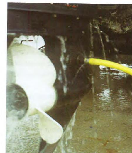
2 Des oreilles placées de part et d'autre de la prise d'eau permettent un rinçage efficace des moteurs hors bord.
