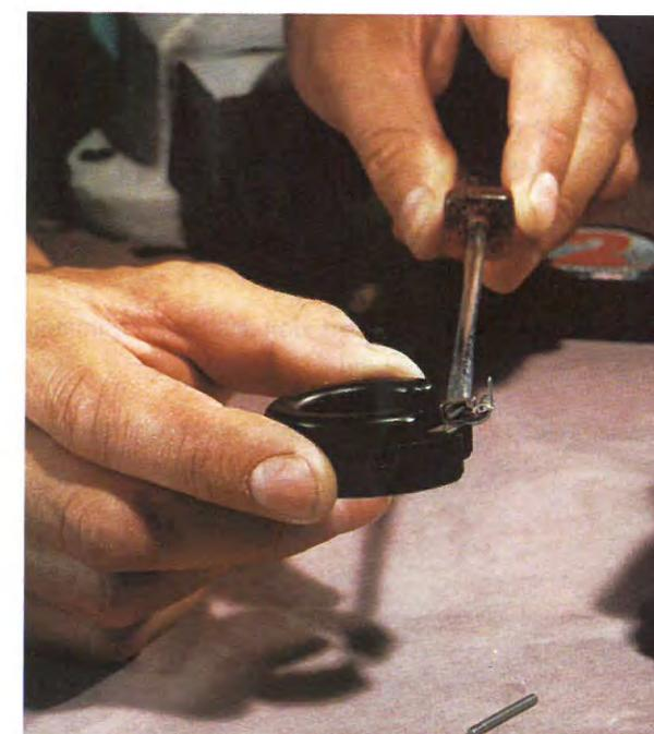
4 Vous pouvez régler la hauteur du niveau de cuve en pliant la languette d'appui du flotteur. Attention cette opération est très délicate, agissez avec par petites touches.
