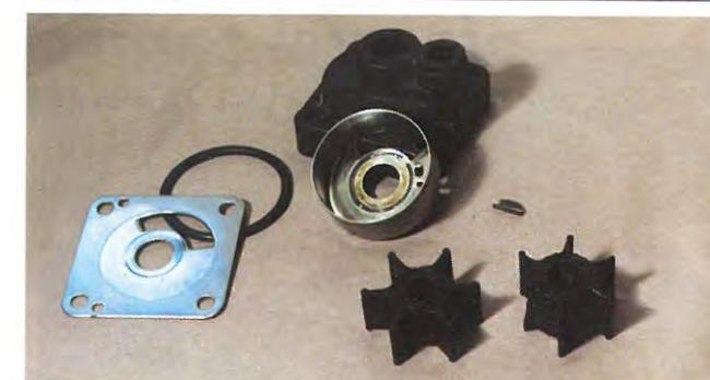
4 Contrôlez l'ensemble des éléments de pompage : rayures sur le carter et sur la plaque, déformation et usure du rotor, état de la clavette. Au moindre doute, changer le ou les éléments défectueux.
