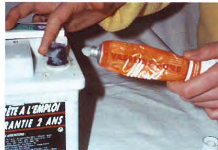
2 Un peu de graisse neutre appliquée sur les bornes limite le sulfatage.
