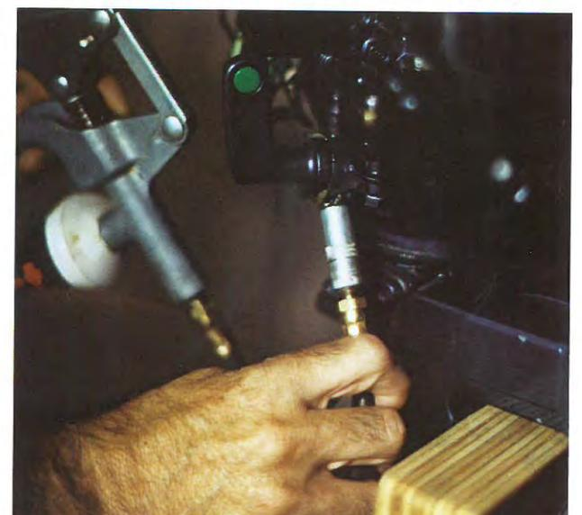
7 Le moteur comporte divers points de graissage à regarnir à l'aide d'une pompe à graisse vendue avec sa recharge par le concessionnaire de votre moteur.
