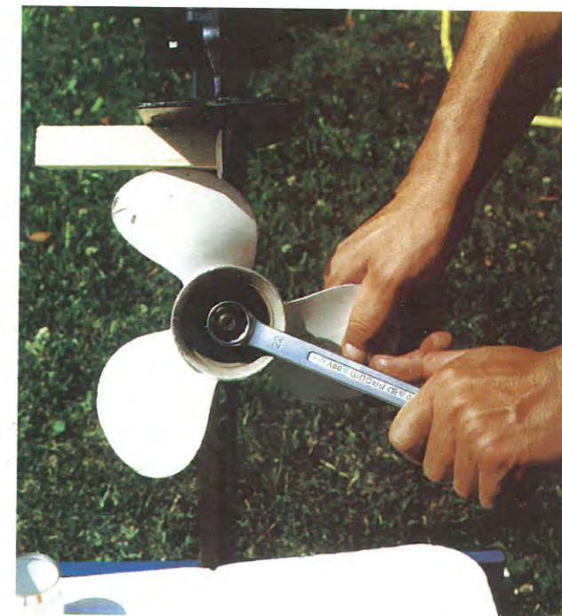
4 Après avoir nettoyé et graissé l'arbre, resserrez l'écrou de l'hélice, reposez puis freinez la goupille.
