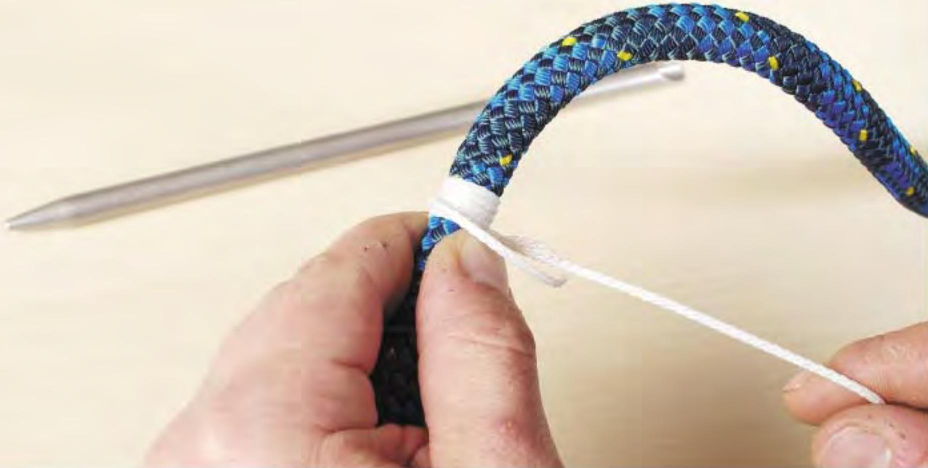
4.9 Posez une 1<sup>ère</sup> surliure provisoire à une distance de  $40 \times$  le diamètre du cordage, en partant de l'extrémité.
