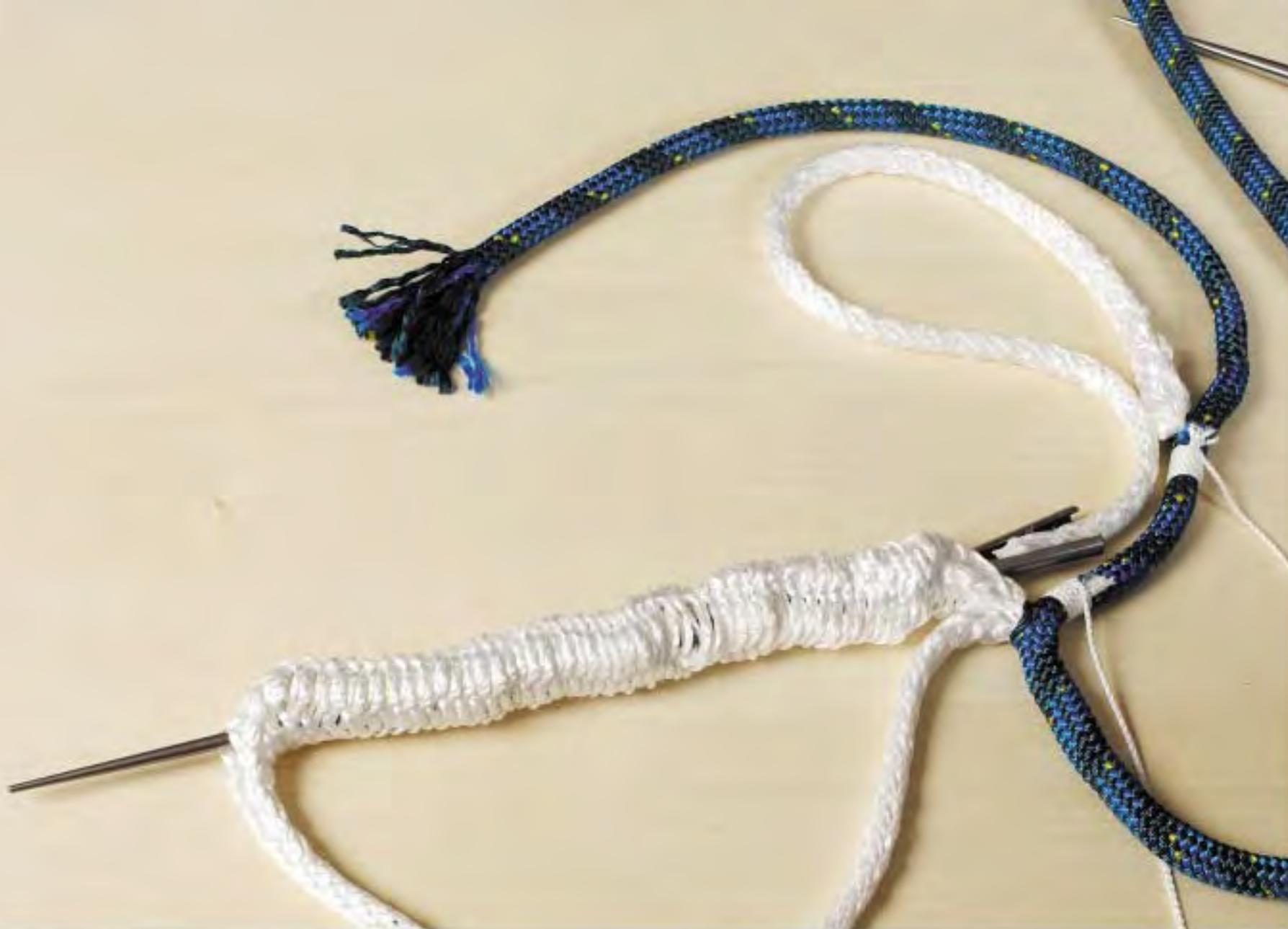
Faites passer l'extrémité dans la boucle, sur une longueur légèrement supérieure à celle de l'extrémité.
