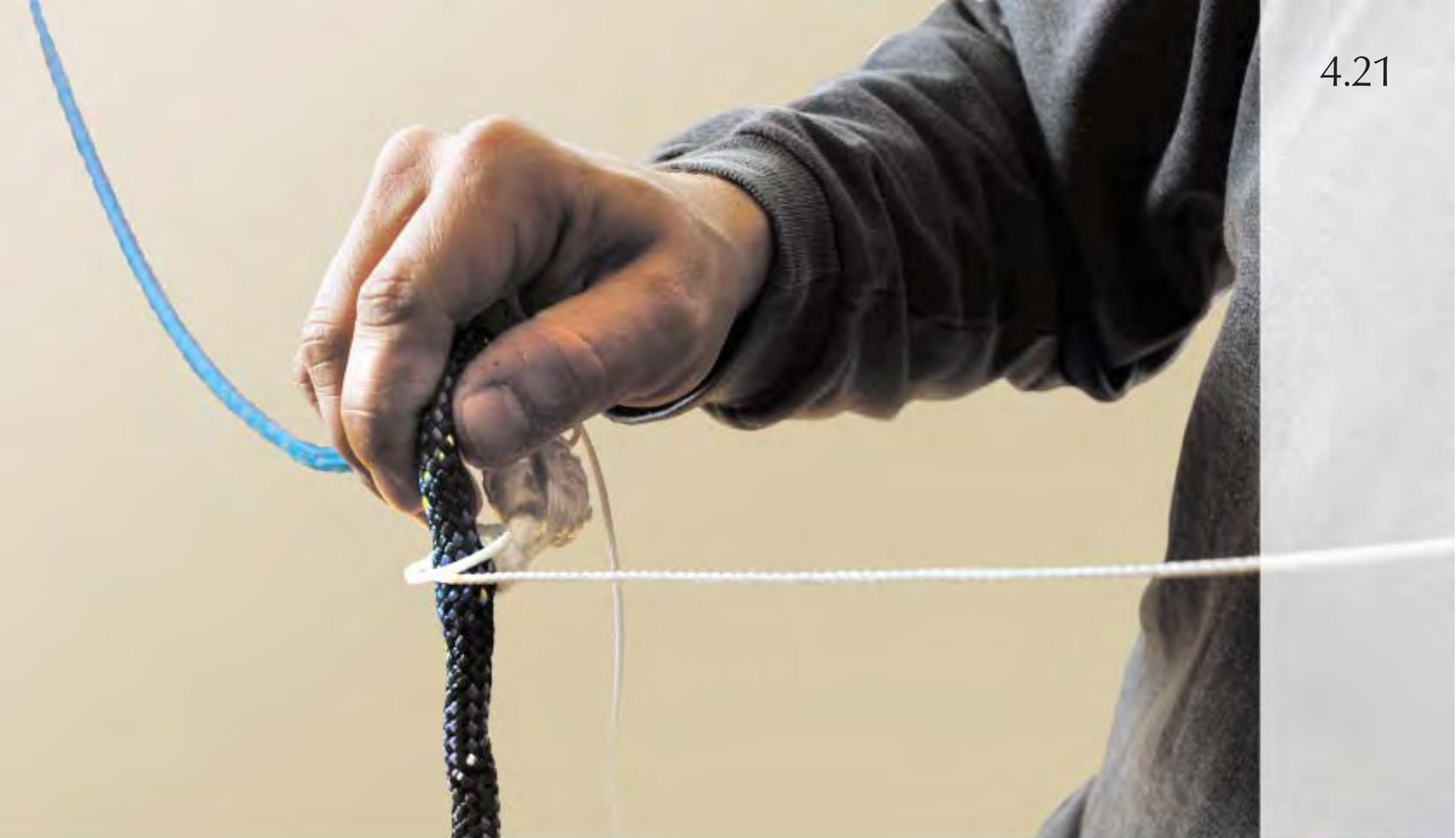
Avant que la boucle ne disparaisse, enlevez les 2 surliures provisoires, afin que l'œil se positionne parfaitement.
