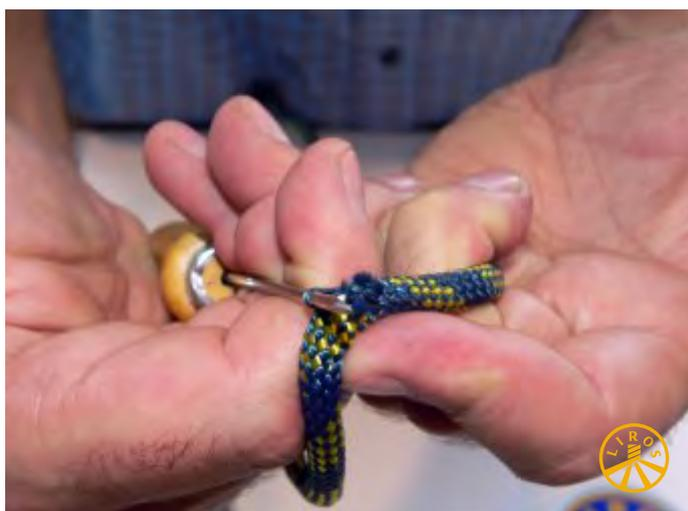
2. Jeweils 5 m von den gerissenen Seilenden entfernt einen Knoten setzen um das Rutschen des Mantels zu vermeiden.
