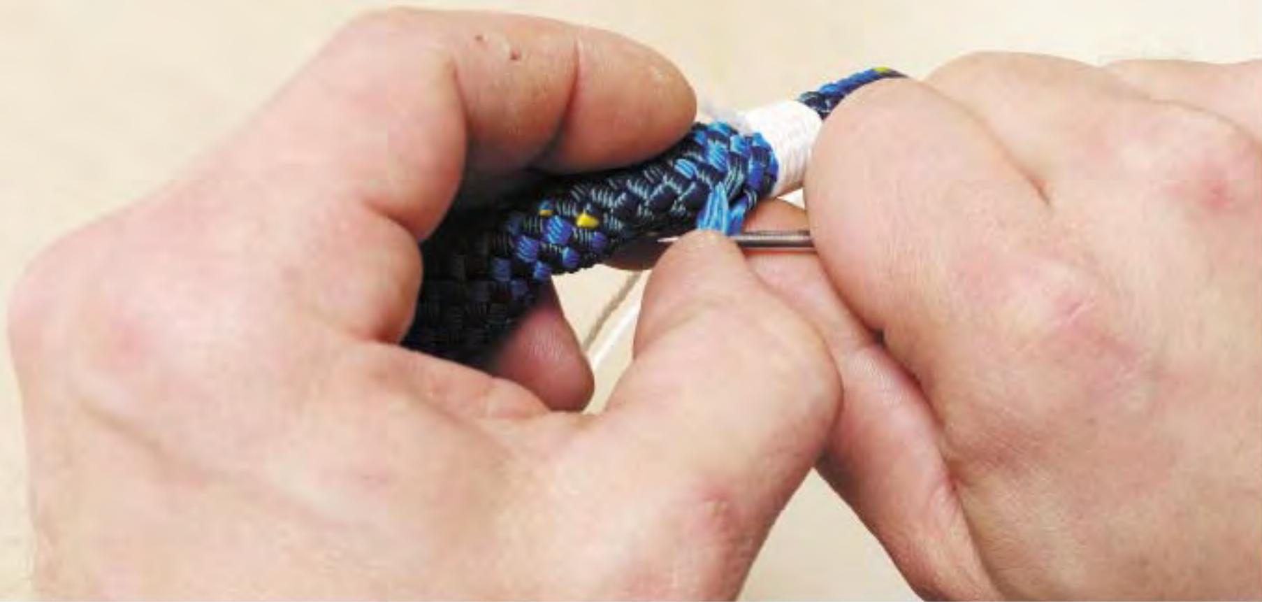
A l'aide du bout de l'aiguille ou d'une pointe, faites sortir l'âme de la gaine, exactement à l'extrémité de la 1<sup>ère</sup> surliure que vous avez posée (direction extrémité du cordage).
