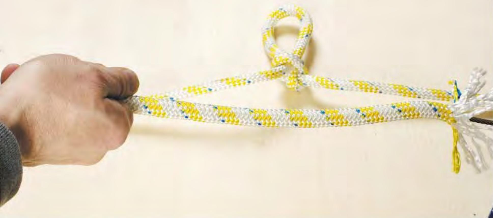
Faites repasser la gaine «retroussée» sur l'âme, en faisant disparaître l'épissure.
