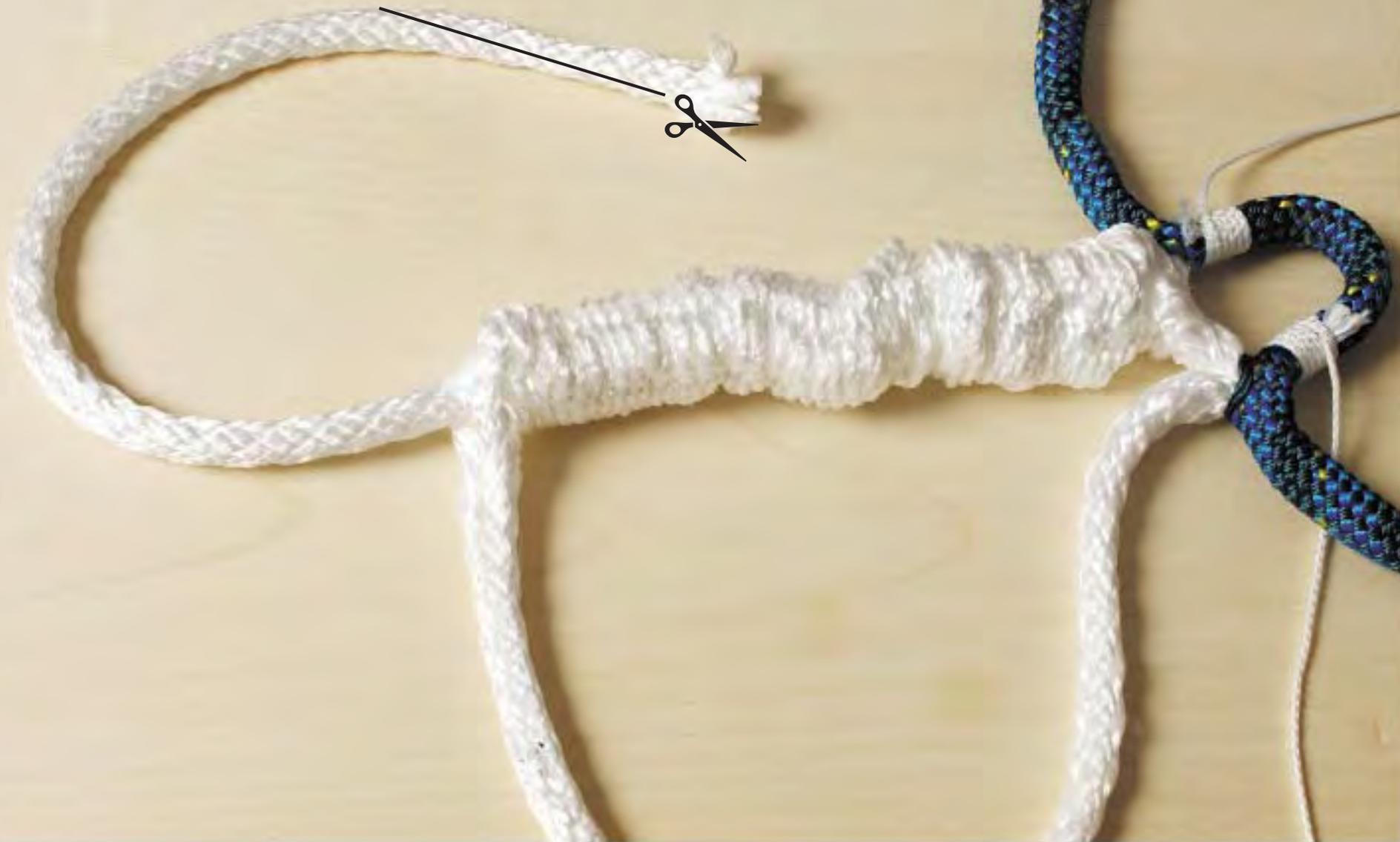
Dégraissez en réduisant le nombre de fils constituant l'âme sur 5 cm.
