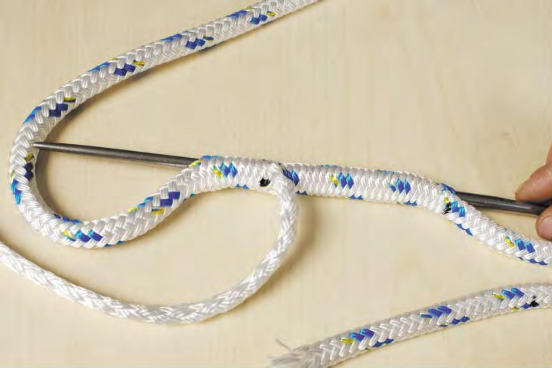
Fixez une gaine dans l'aiguille, et rentrez au point 15 cm de l'autre extrémité. Ressortez au point 30 cm, ou mieux: 2cm après ce point.
