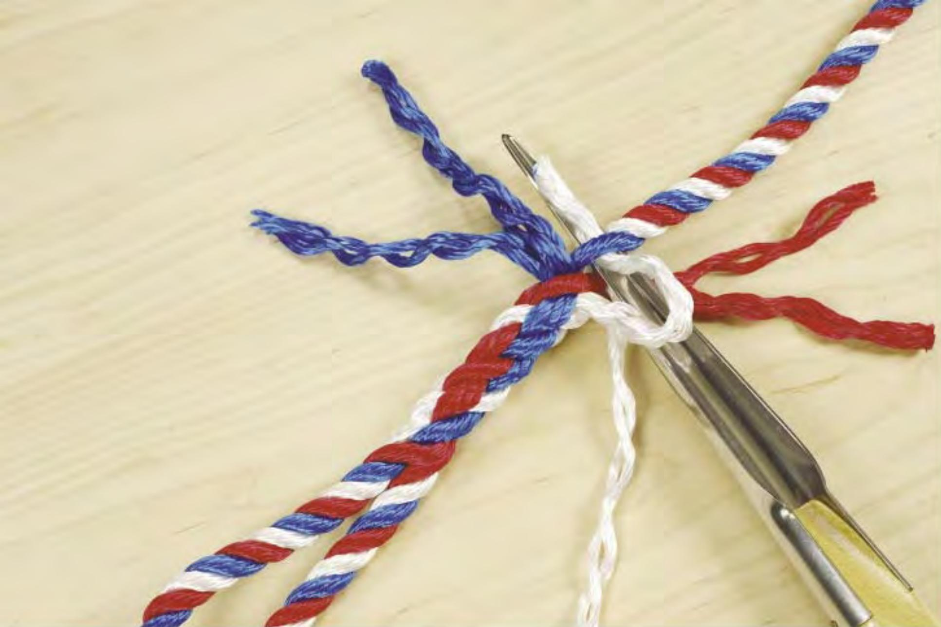
Passage avec le toron «dégraissé» (à partir de 14mm).
