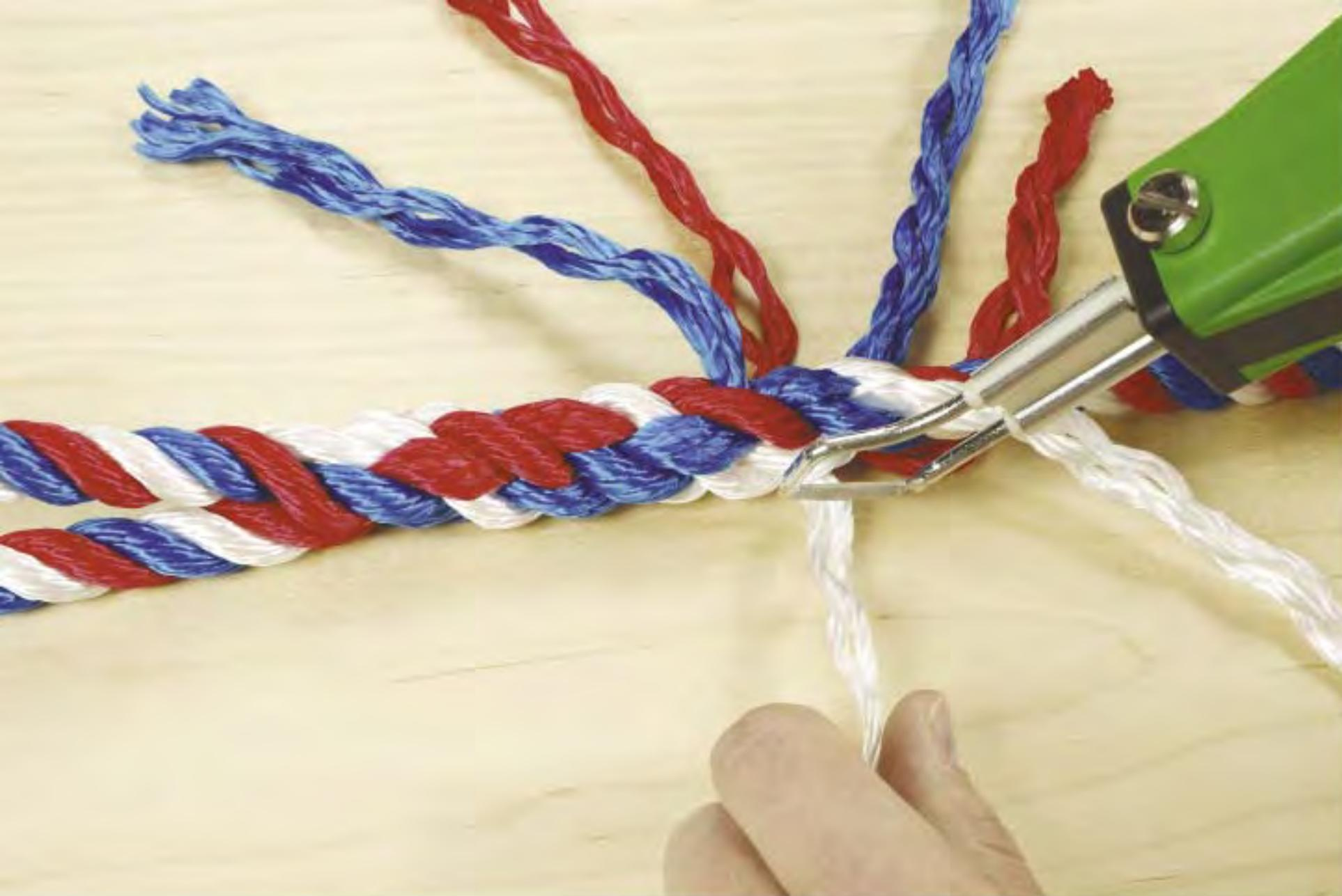
Coupe à chaud des fins de torons. Ne pas couper à ras: laissez env. 3mm, qui vont se positionner à ras dès que le cordage sera sous traction.
