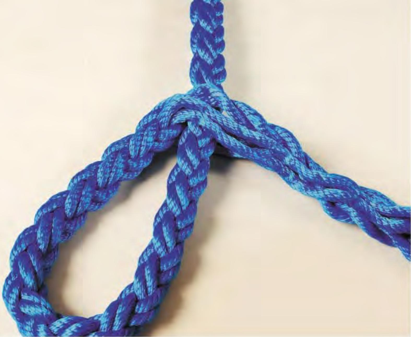
Déterminez la taille de la boucle, et faites passer la moitié des torons sur, et l'autre moitié sous le cordage.
