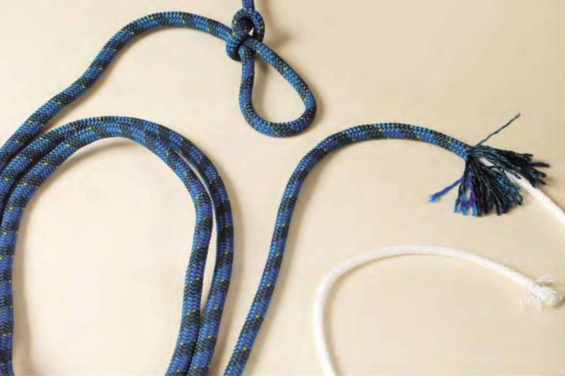
\* Dégagez l'âme sur une longueur égale à  $80 \times$  le diamètre du cordage (par ex. 10 mm = 80 cm) + la longueur de la boucle (uniquement pour les articles avec gaine intermédiaire).
