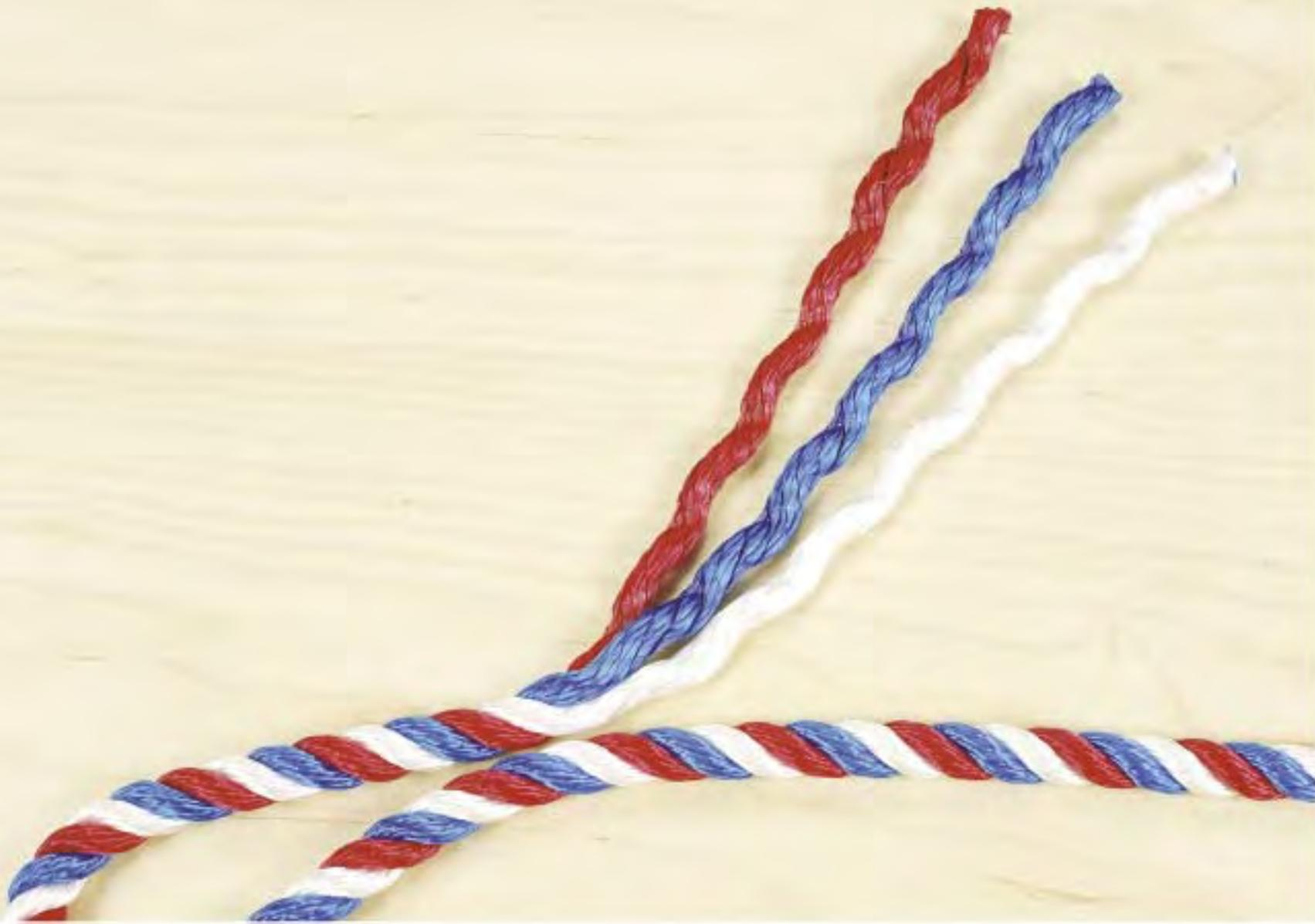
Si les extrémités des torons ne sont pas lisses, les «arrondir» avec le fer à couper, ou les couvrir avec un peu d'adhésif.
