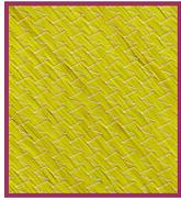
Souvent appelée KEVLAR®, la fibre d'aramide est issue de la chimie des polyamides aromatiques. Il est possible de trouver deux types de fibres d'aramide de rigidités différentes :
