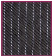
C'est la fibre la plus utilisée dans les applications hautes performances. Elle est obtenue par carbonisation de la fibre de PAN (Polyacrylonitrile). Selon la température de combustion, on distingue deux types de fibres :
