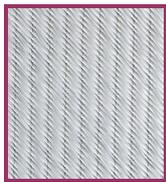
Elles constituent le renfort essentiel des composites de grande diffusion. Elle est obtenue à partir de sable (silice) et d'additifs (alumine, carbonate de chaux, magnésie, oxyde de bore). On distingue trois types de fibres :
