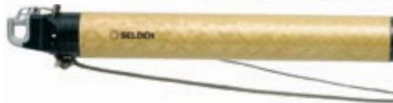
Protection en Twaron en option. Les filaments de Twaron protègent le tangon contre le ragage sur l'étai ou les haubans.
