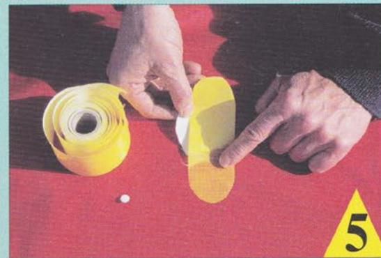
5 On commence par mettre la petite pièce en amorce de la déchirure. Pour éviter les plis, aussi bien sur la voile que sur la pièce, il faut décoller au fur et à mesure le support papier et appliquer la pièce avec un doigt en appuyant fermement.
