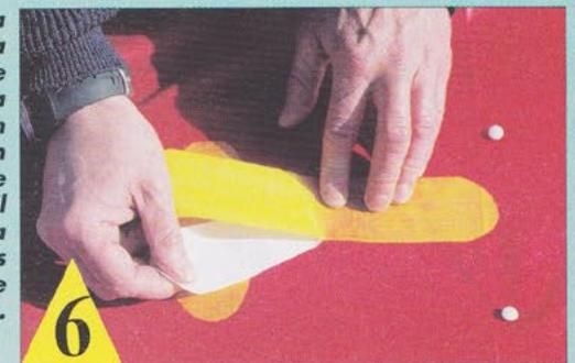
7 Il faut procéder de la même façon pour l'autre côté de la voile, en découpant les deux pièces aux mêmes dimensions et en les appliquant l'une après l'autre. Cette réparation peut tenir très longtemps si elle n'est pas située à un endroit où les efforts sont importants.
