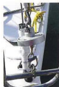
Le système d'enroulement peut s'amurer directement sur le balcon avant.
